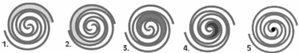
Figura 3.20 - Processo de compressão em um compressor Scroll
