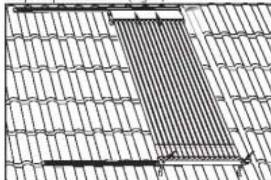
Fig. 7: Atornillar el colector
