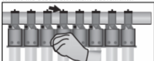
Fig. 21: Introducir el fijador de plástico nuevo
