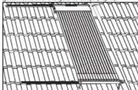
Fig. 6: Colocar el colector sobre las guías
