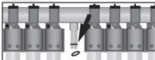
Fig. 19: Retirar las juntas
