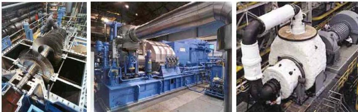
**Figura 9 – Exemplos de turbinas a vapor usadas na Cogeração**
