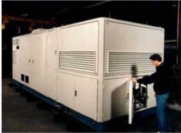
Figura 19 – Sistema de cogeração utilizando Pilhas de Combustíveis
