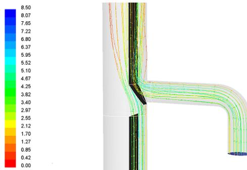
**FIGURA 3.-** Líneas de corriente coloreadas por velocidad (modelo 1). Descarga a la altura de la 2ª planta.
