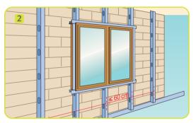
Colocar os montantes encaixandoos nos canais. Caso seja necessário utilizar lã mineral com barreira de vapor, esta colocar-se-á contra a placa PLADUR® ou pode-se utilizar directamente a placa PLADUR® BV.
