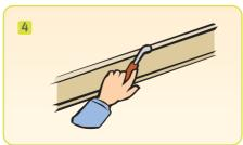
4 Preencher as uniões com pasta de juntas, usando uma espátula. Para um acabamento de alta qualidade recomenda-se a texturização de toda a superfície com pasta de juntas PLADUR® usando um pincel com esponja.
