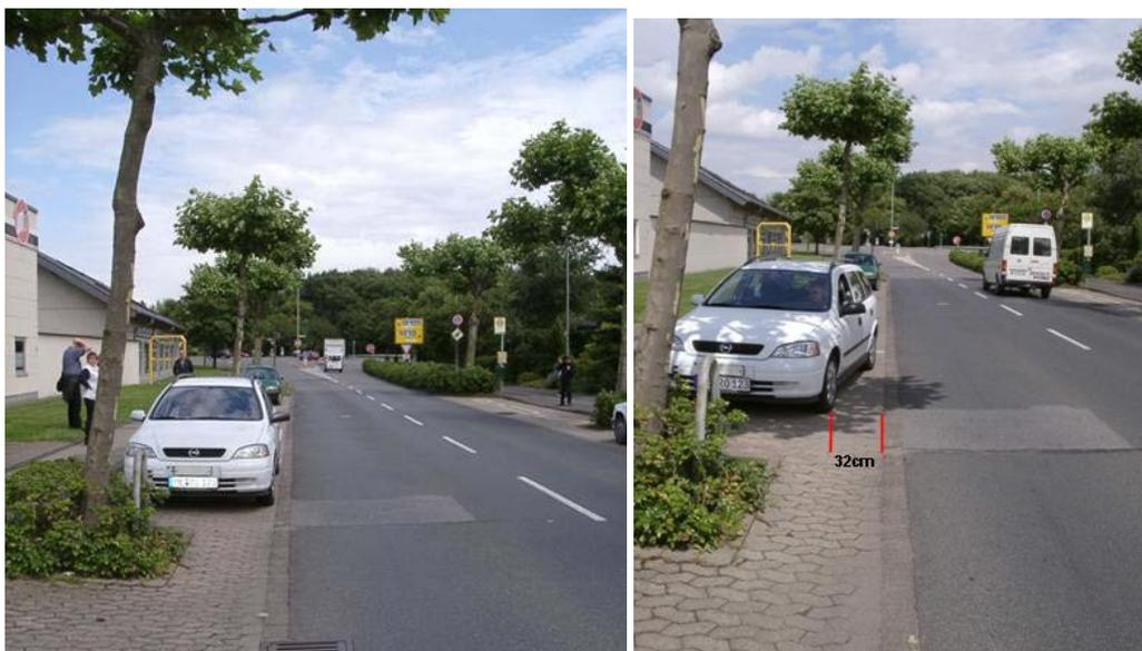
Figura 2a: Posicionamento do veículo com antena paralelo à faixa de rodagem (lado esquerdo) e com parte dianteira afastada de 32 cm (lado direito).
