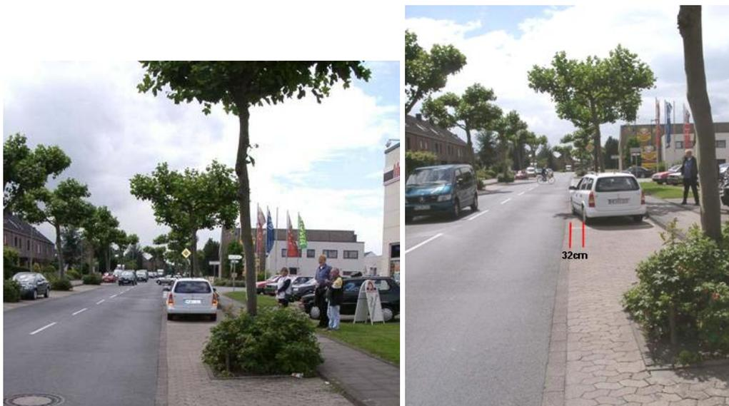
Figura 2b: Posicionamento do veículo com antena paralelo à faixa de rodagem (lado esquerdo) e com parte traseira afastada de 32 cm (lado direito).
