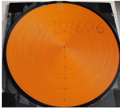
Imagem 9.4 - Bobina em espiral em fabrico
