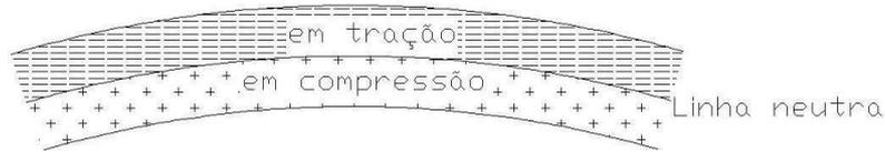
Imagem 8.2 - Vista de parte de uma folha de chapa em tensão
