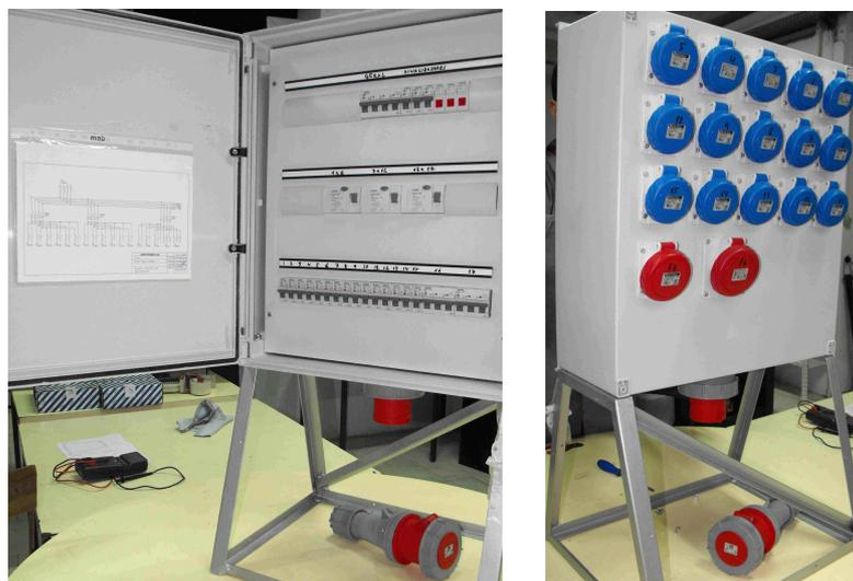
Imagem 8.9 - Quadro de 63A, do circo VHC com estrutura de suporte e tomada macho de alimentação
