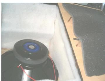
Interior da coluna de graves com reforços anti-vibração e material absorvente
