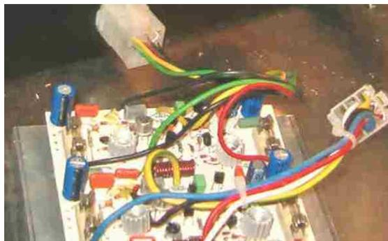
Modelo duplo a "mosfets" de 2004 funciona até 2x100VDC máximo 200W RMS a 8 $\Omega$
