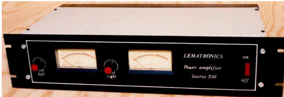
Amplificador com traseira em dissipador U, até 2 x150W/8
