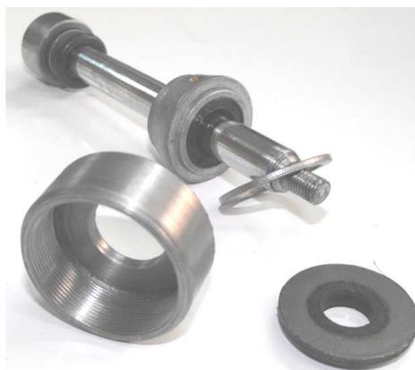
Imagem 1.19 - Porca e veio fabricados para o amortecedor traseiro
