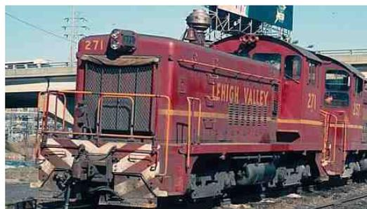
Imagem 1.16 - Comboio com "spark-arrester" no escape
