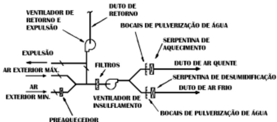
Figura 7.8. Instalação com somente um ventilador de insuflamento e serpentina de desumidificação na descarga do mesmo.
