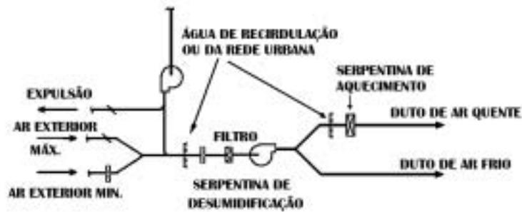
Figura 7.12. Instalação com somente um ventilador e serpentina de desumidificação na sucção do mesmo.
