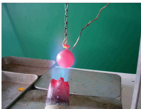
Imagem 3.2.3.2.1 - aquecimento da esfera de 37mm
