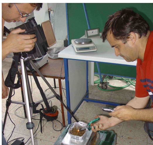
Imagem 3.2.2.1 - medição de temperatura por camara de infravermelhos
