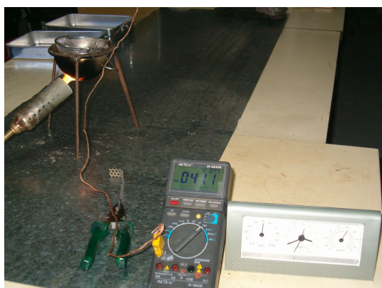
Imagem 3.2.1.1 – Aquecimento das esferas por imersão em metal líquido, e uso de multímetro/ termopar
