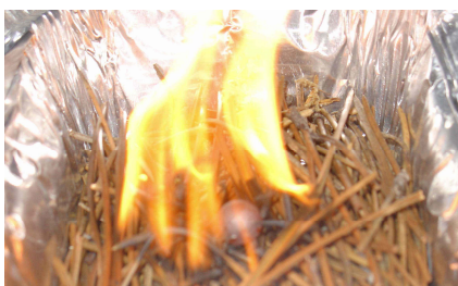
Imagem 3.2.2.2 – Ensaio de ignição com caruma, 13/06/2005
