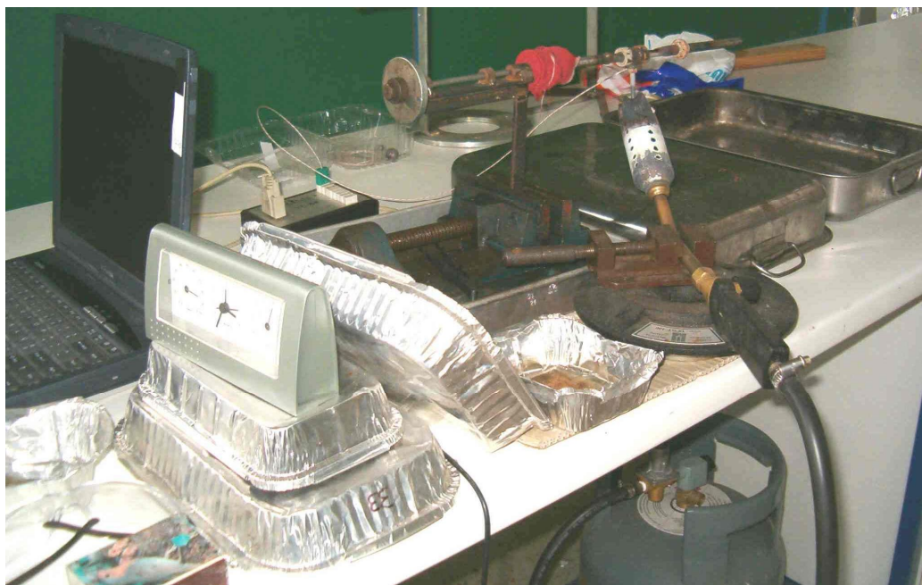
Imagem 4.1.4 – Dispositivo de ensaio para projeção de partículas de escape por explosão, 21/10/2005
