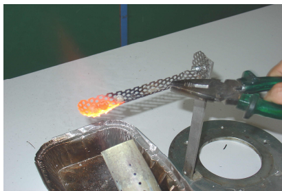
Imagem 3.2.1.2 – Aquecimento das esferas por propano
