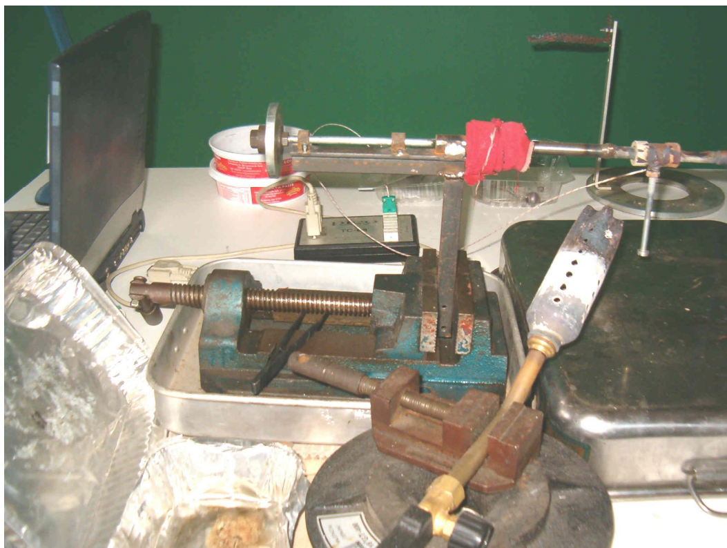
Imagem 3.2.3.4.1 - aquecimento da fuligem seguida de explosão
