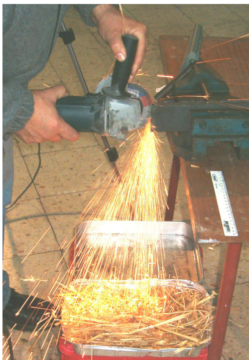
Imagem 3.2.3.3.1 – Ensaio de projecção de partículas incandescentes de aço em feno, 9/11/2005
