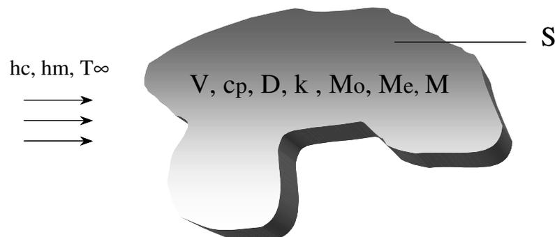
FIGURA 1. Esquema representativo do processo de secagem de um sólido com geometria qualquer.
