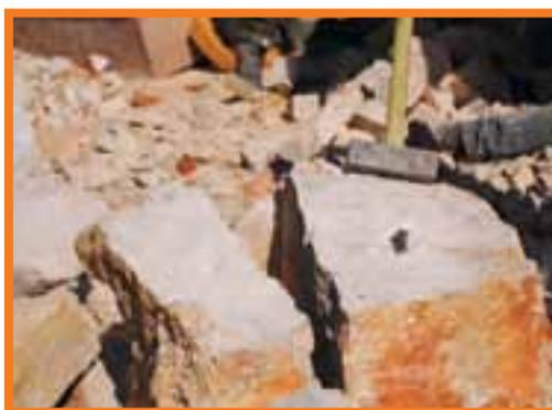
Figura 10 - Depois da colocação do guilho e das palmetas no furo, percute-se o guilho com uma marreta de 6 a 8 kg até se fracturar a massa de pedra.
