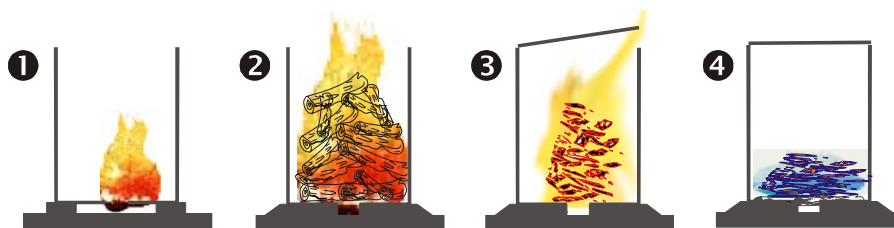
Figura 3 - Esquema do método directo de fabrico do carvão de madeira
