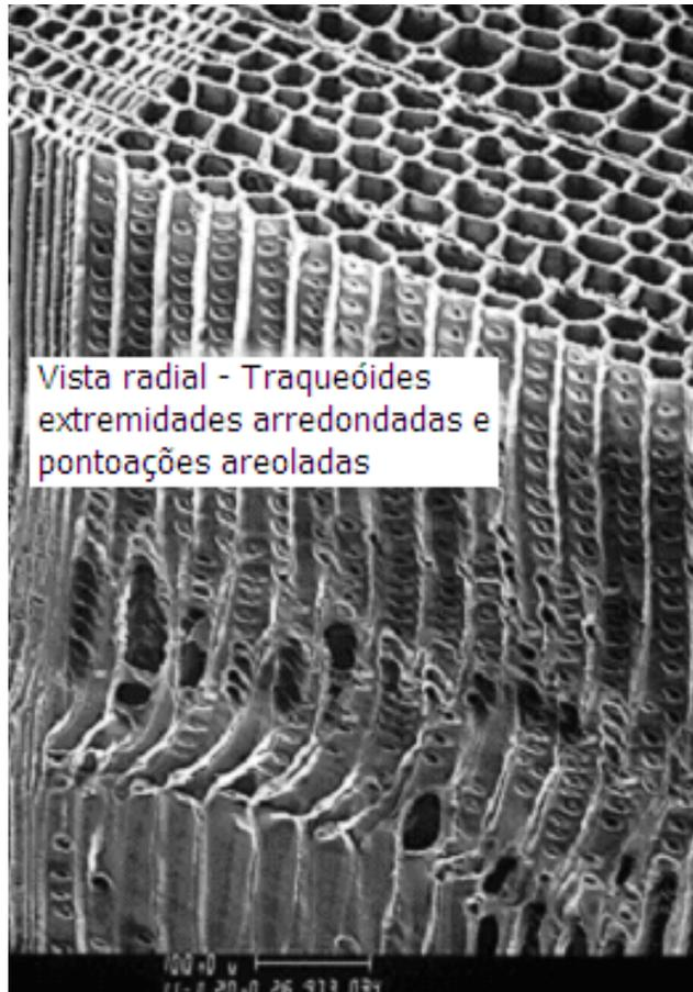
FIGURA 8 – Fotomicrografia da madeira de uma conífera, mostrando os traqueóides com pontuações. (Fonte NCSU. Wood Anatomy Classes, WHEELER, 2000)
