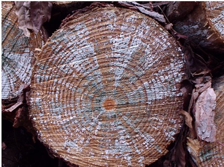
FIGURA 16 – Topo de tora verde de *Pinus* spp estocada ar livre com a presença de fungos de bolor e início de biodegradação (Foto MARIN, 2005).
