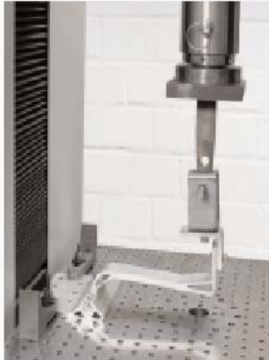
Anclaje para cubierta Pfanne 3 Al Prueba de fuerza de presión
