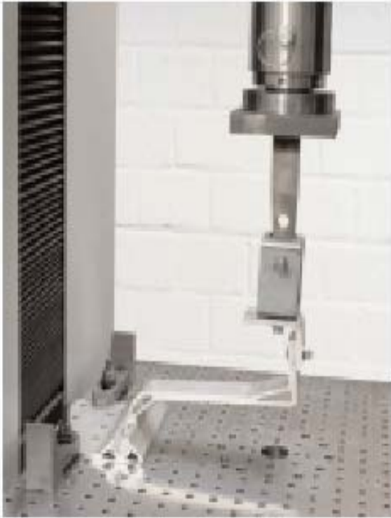
Anclaje para cubierta Pfanne 3 Al Estado original
