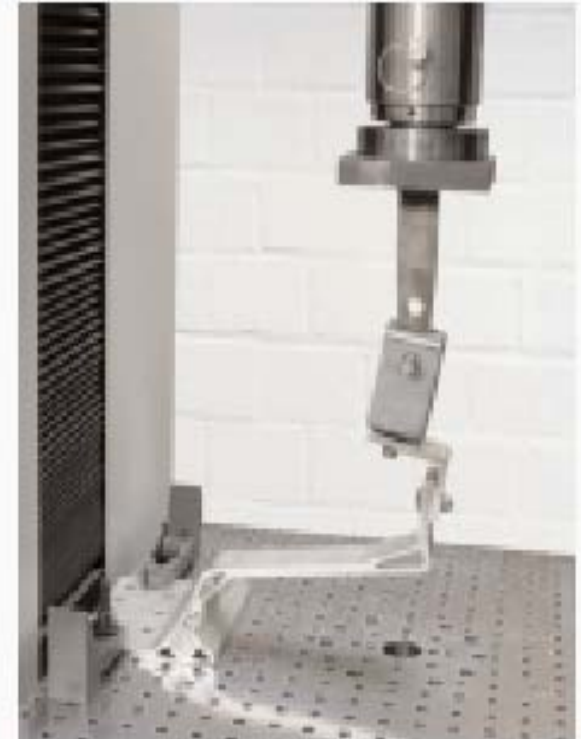
Anclaje para cubierta Pfanne 3 Al Prueba de fuerza de tracción
