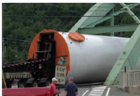
Fig.2 – Dificuldade em passar o 1º segmento de uma torre eólica por ponte devido ao grande diâmetro.
