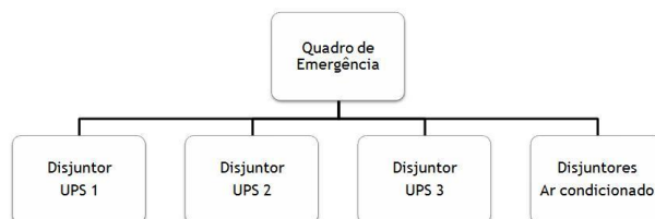
Figura 4.4 - Hierarquia do Subsistema Quadro de Emergência
