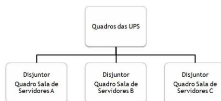
Figura 4.6 - Hierarquia do Subsistema Quadro das UPS
