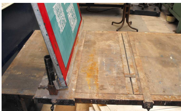
Imagem 2.4 - Mesa de serigrafia com o quadro levantado
