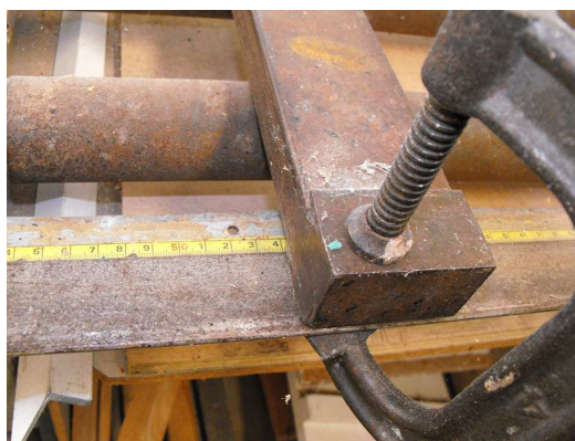
Imagem 2.2 - Vista em pormenor da fixação da régua
