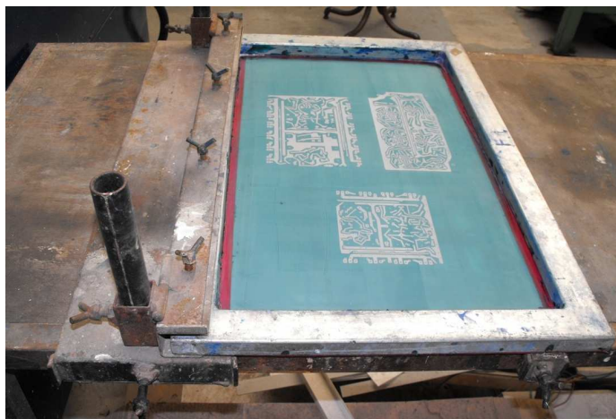
Imagem 2.3 - Mesa de serigrafia com quadro sensibilizado
