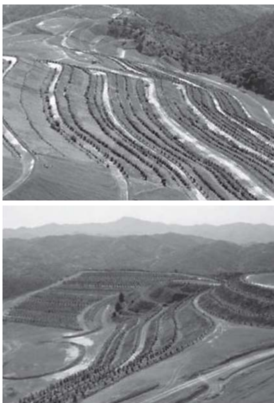
Figura 5.11: Mina de asbestos de Troodos Mountain durante a recuperação mostrando as escombrelas e plantações.
